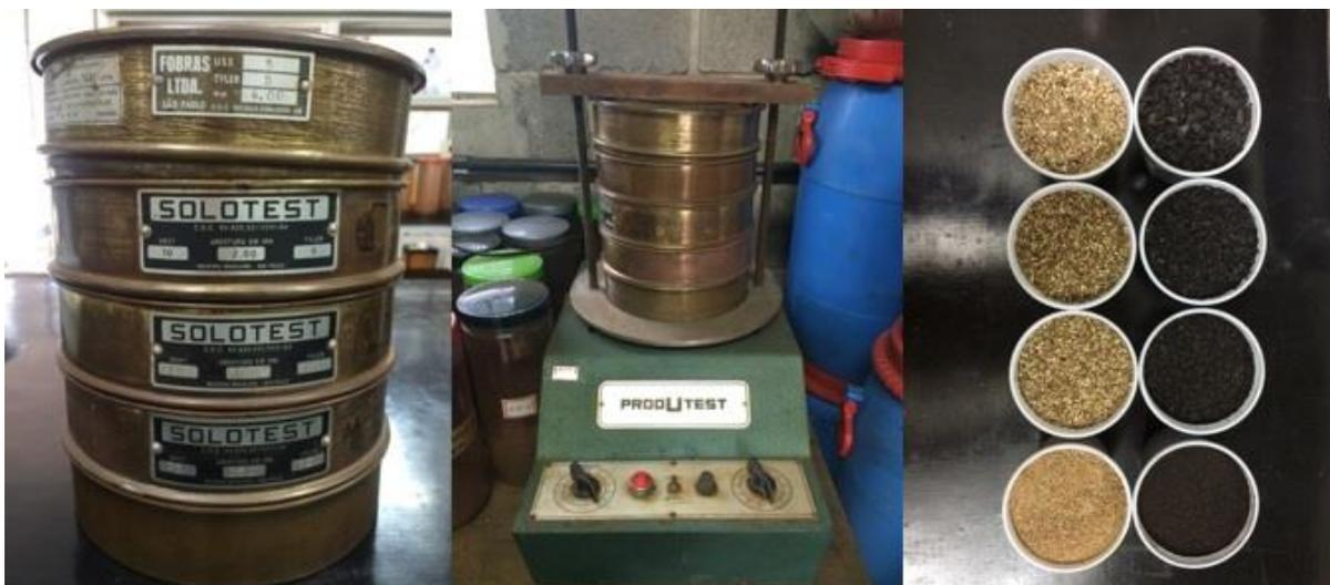
**Figura 2.** Jogo de peneiras e tamisador vibratório utilizados para separação do carvão vegetal e da vermiculita em diferentes granulometrias.
