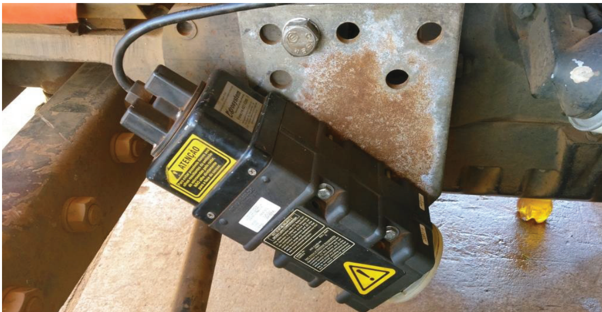
Figura 11 - Radar DJRVS-II acoplado ao trator para a realização dos testes. Fonte: A autora (2015).
